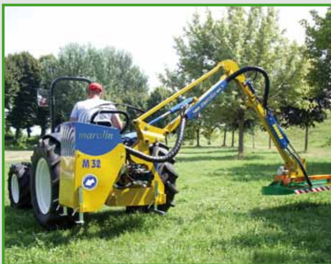
Schwimmstellung (Bodenanpassung des Mähkopfes)
